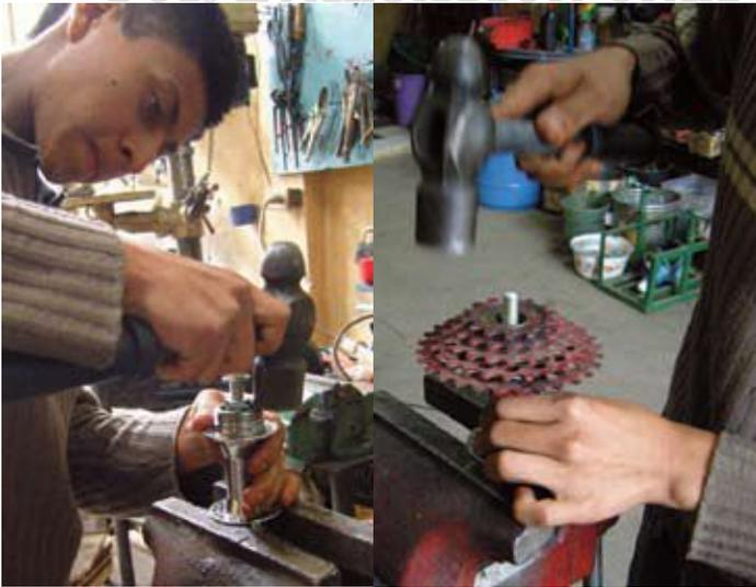
La rueda se hace de una llanta de 20". Ambos extremos del eje deben estar gastados para aceptar la estrella. Esto se puede lograr ya sea cortando o sustituyendo uno de los lados del eje y la reconstrucción de la rueda. La soldadura es la opción más fácil, pero tienden a causar oscilaciones no deseadas en el cassette.
