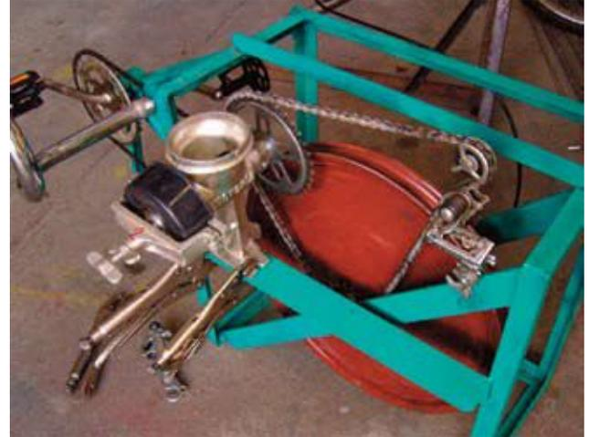
Este desviador esta colocado de forma inversa y colocado en posición rígida. Los ajustes son hechos usando los tornillos.
