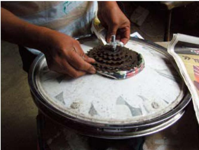
El molde para el concreto esta hecho por un cobertor de llanta de bicicleta de niños. Estos son difíciles de conseguir, así que se tendrá que improvisar. Se mantiene en posición con la ayuda de un juego de piñones de bicicleta y embalsado con papel periódico para evitar fugas.
