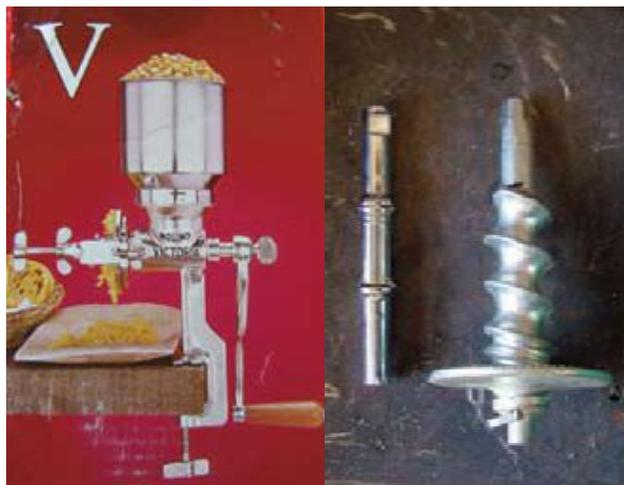
La maquina de moler es operada a mano y montada en una mesa. Remueva el eje central. Un extremo es tomado por la palanca, el otro extremo forma parte del mecanismo para moler. La parte de la palanca es cortada completamente...
