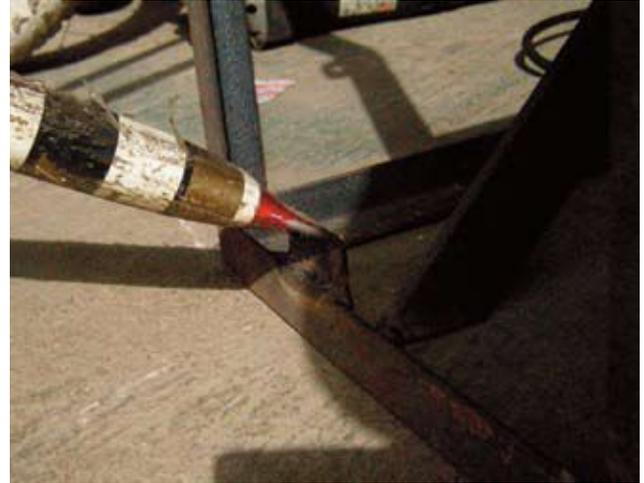
para obtener una mejor adherencia, la armazón se aplana y se dobla antes de soldarse a el chasis.
