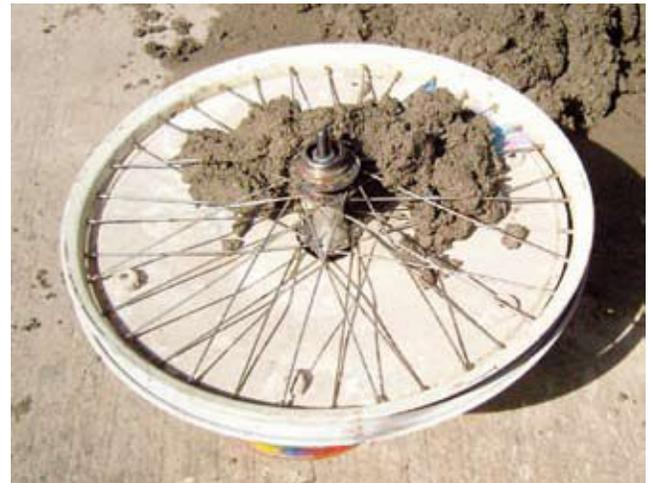
Mezcle el cemento con arena por las dos partes. Coloque las ruedas sobre un cubo para darle soporte.
