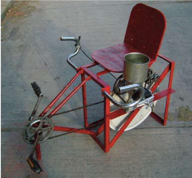
**La mejor venta de “Bicimaquina” de Maya Pedal. Este diseño provee un sistema estable de pedal de fuerza para sentarse y hacer funcionar numerosos tipos de funciones. En Guatemala es usado fundamentalmente para desgranar y moler maíz utilizando estos dos dispositivos poderosas de uso manual encontrados en la localidad. Cada dispositivo tiene que ser adaptado al pedal de fuerza modificando el eje central para incorporar**
