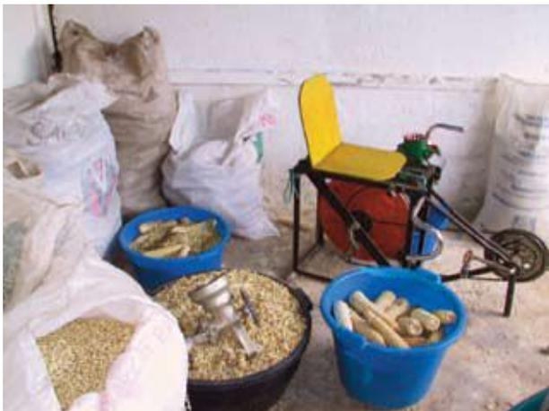
La armazón principal esta hecha de acero y una sección de juego de estrella y cadena cortada de una armazón de bicicleta vieja. El desviador de cambio mantiene la cadena en buena tensión y también provee un método para realizar los cambios.
