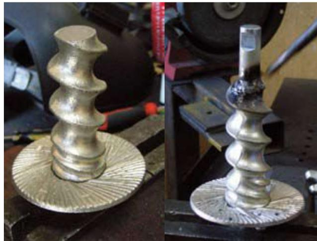
...y parte del eje de manubrio "cotted"\* es soldada en esa parte. Debe de quedar justo en la medida. Nosotros usamos electrodos diseñados para fundir acero para soldar esta parte.
