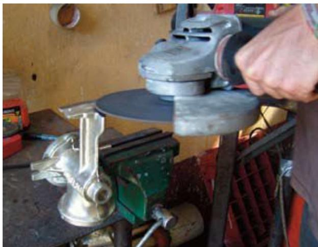
la maquina de moler será atornillada eventualmente en la armazón. Corte la parte utilizada para montar en la mesa, como se muestra; dejando un borde plano y cuadrado.
