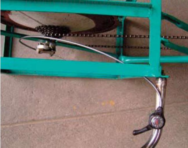
Ahora puede ajustar una palanca de cambios. Una de simple fricción es mejor que una palanca de índices. Use el tornillo para ajustar que se encuentra en el desviador para asegurarse que todos los cambios pasan bien sin que la cadena se salga.
