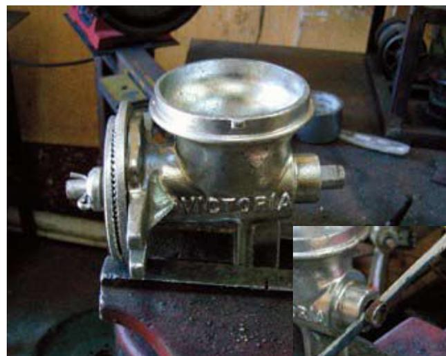
nuestro manubrio adaptado necesita una pipa de calce para ajustar. Inserte una si es necesario y corte cualquier exceso.
